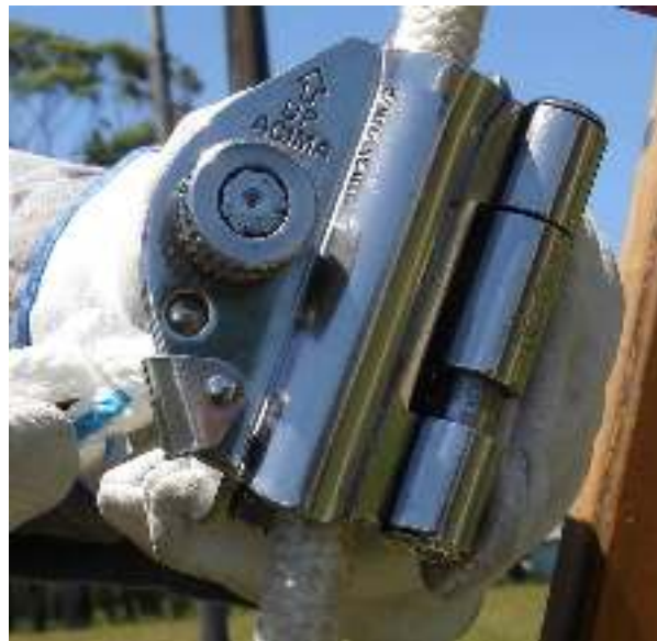
Figura 30 - Fechamento e travamento do trava-quedas
