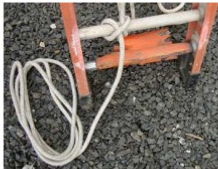
Figura 17 - Nó fiel na base da escada
