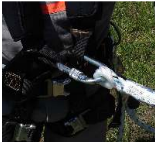
Figura 28 - Instalação do trava-quedas no cinto paraquedista
