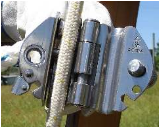
Figura 29 - Instalação do trava-quedas na linha de vida
