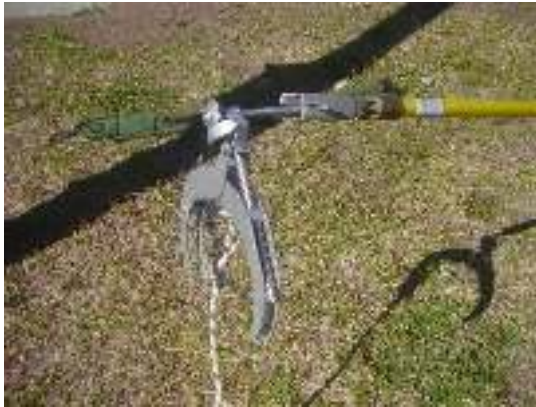
Figura 21 - Encaixe da garra na ponteira da vara de manobra
