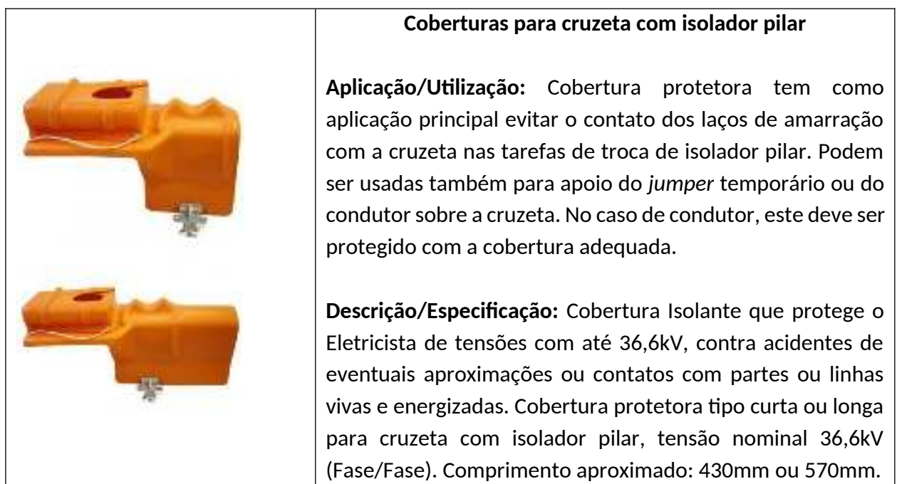
Figura 108 - Coberturas para cruzeta com isolador pilar
